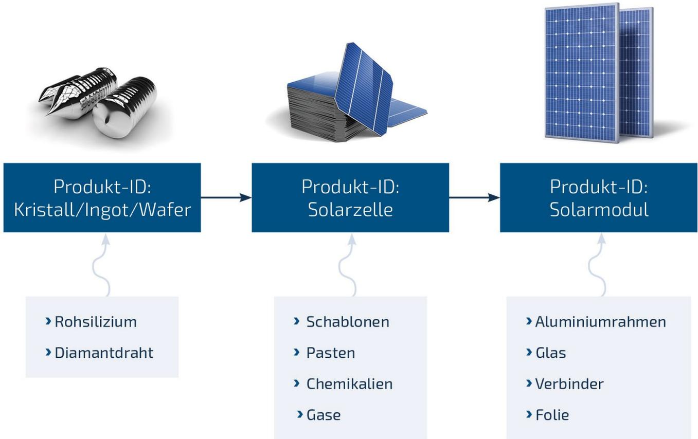
Produktdaten werden für jedes Produkt (Wafer, Zelle, Modul) bezogen auf eine Produkt-ID gesammelt. Alle Material-, Prozess- oder Messdaten werden so rückverfolgbar bis zum Ursprungsmaterial erfasst.
