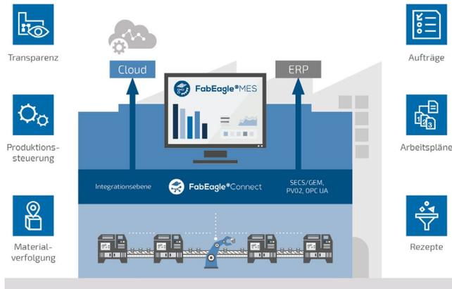
FabEagle®MES ermöglicht dank seiner Funktionsmodule die volle Transparenz und Kontrolle der Produktion. Das System wird mittels FabEagle®Connect als Low-Code-Integrationslösung in die System- und Hardwarelandschaft integriert. Zu berücksichtigen sind besonders PV-spezifische Schnittstellenstandards wie PV02 und SECS/GEM, die aus der Halbleiterbranche kommen.
